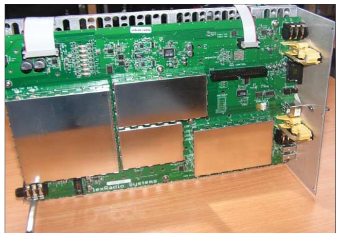
Bild 3: Die Ansicht der Trägerplatte von unten zeigt das HTRX-Board. Hermetisch abgeschirmt sind Frequenzbearbeitung, 11-poliger Tiefpass, RX-Mischer mit 24-Bit-A/D-Umsetzer sowie Firewire-Interface.
